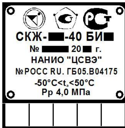
Рисунок 2 – Табличка блока измерительного
