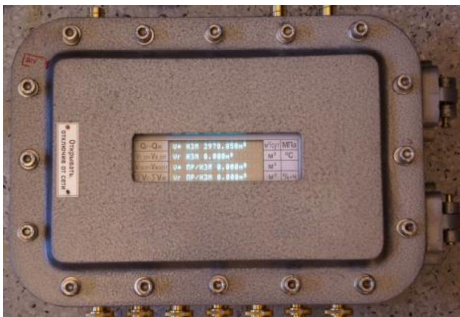
Фото 2 - Фотография блока измерений и обработки информации БИОИ-2
